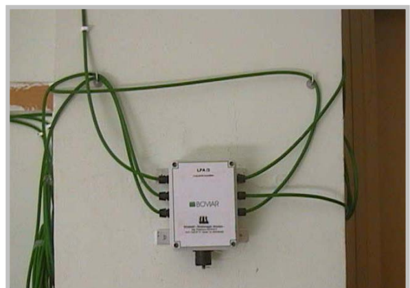
FIG.7,8 – SENSORI DI SPOSTAMENTO E CENTRALINA DI ACQUISIZIONE
