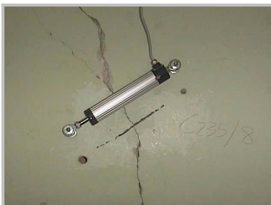
FIG.7,8 – SENSORI DI SPOSTAMENTO E CENTRALINA DI ACQUISIZIONE
