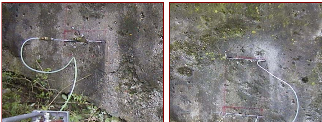
Figura 2.3 – Prova con martinetto singolo e doppio
