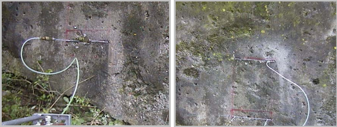
Fig.2,3 – Prova con martinetto singolo e doppio
