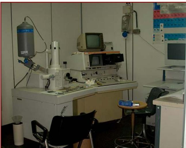
Fig.3 - Microscopio elettronico a scansione
