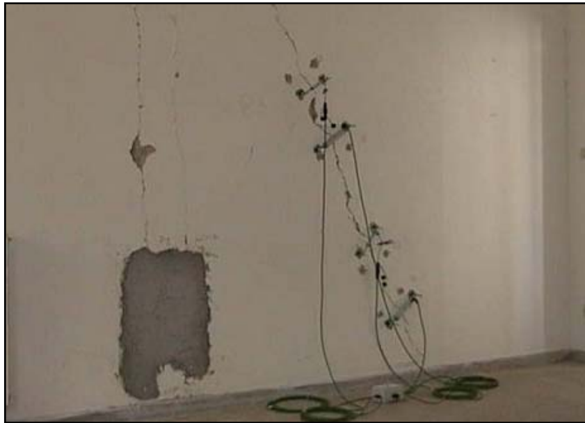
Fig.3 – Sensori di spostamento e centralina di acquisizione
