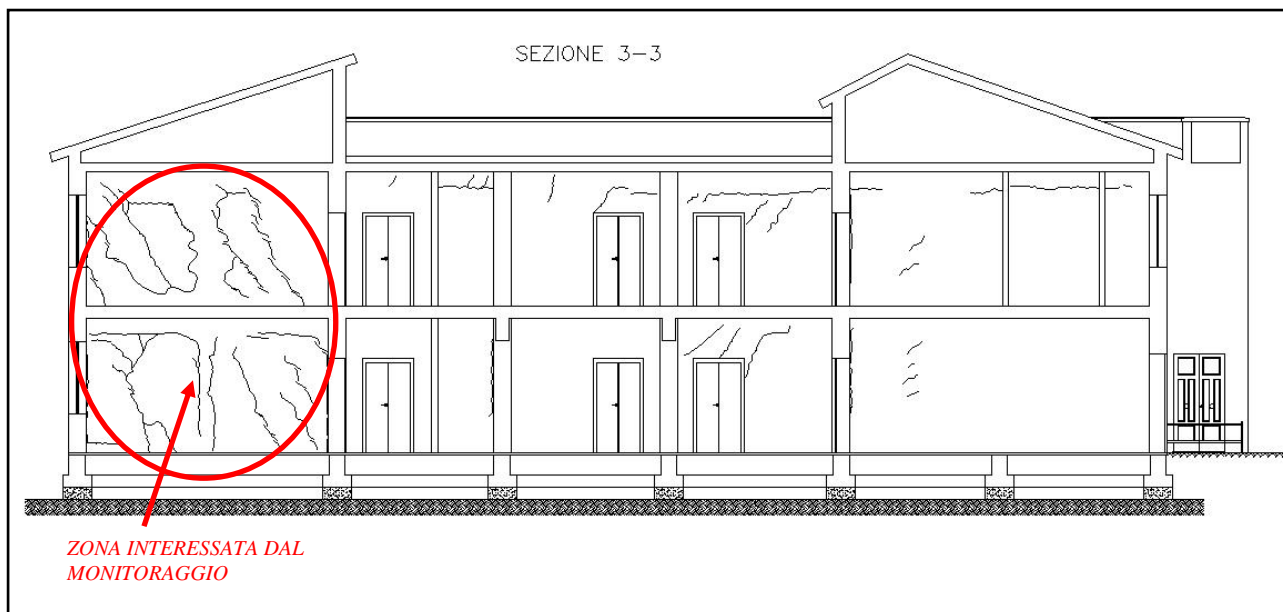
Fig.3: Rilievo del quadro fessurativo – Viste d’insieme
